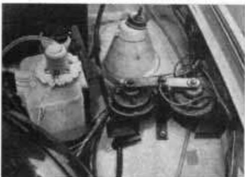
Bild 10 12-V-Scheibenwaschanlage mit Elektropumpe und ECE-gerechte Anbringung der Zweiklangfanfare
