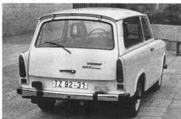
Bild 2 Heckpartie des Universal „S de Luxe“ mit Heckscheibenheizung, Heckwischer, Nebelschlussleuchte und Rückfahrscheinwerfer
