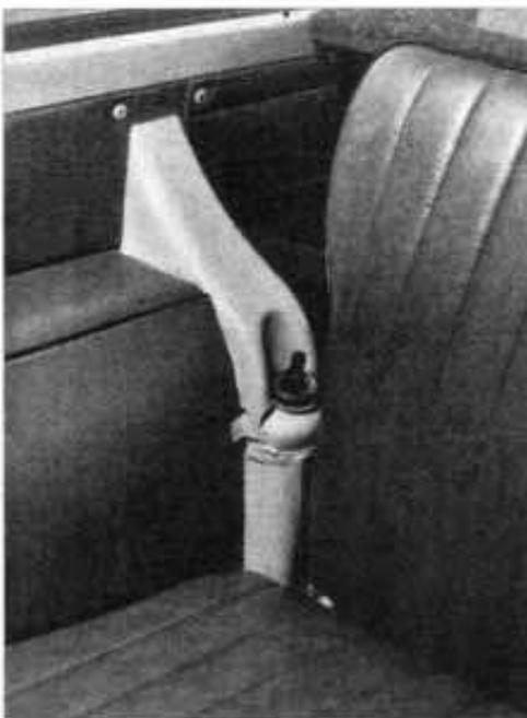
Bild 13 Begrenzung für die Fondsitzebank: Schwingungsdämpfer-Anlenkung und Radschalenverstärkung
