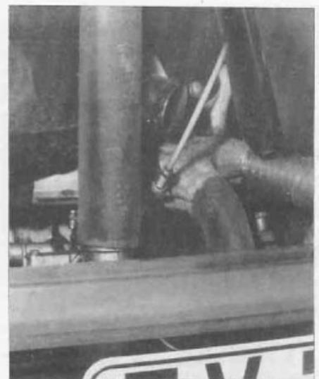
Bild 7 Der Abstand des Luftausgangsrohres vom Abgaskrümmer (Winterbetrieb) beträgt mehr als 10cm (Heizschlauch abgezogen). Eine Luftvorwärmung dürfte hier nur sehr schwach wirksam werden (Fotos: B.)
