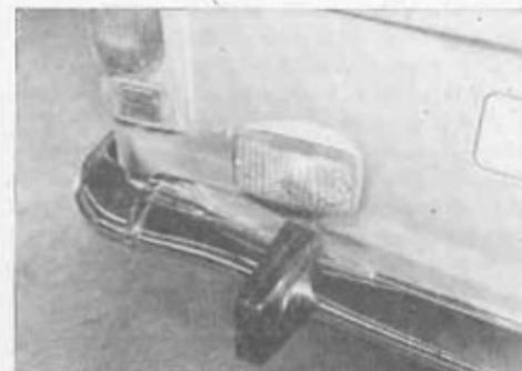
Bild 2 Gummi-Stoßstangenhorn und Nebel-Schlußleuchte
