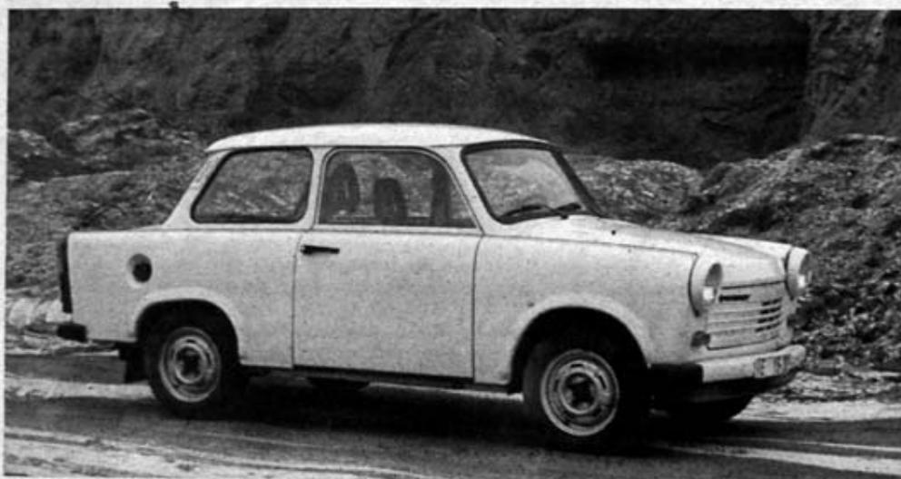
Bild 1 Testwagen Trabant 1.1 aus der Vorserie, dessen Handicap nicht nur im Aussehen liegt. Mit 28 l Tankinhalt beträgt der Aktionsradius nicht einmal 400 km
