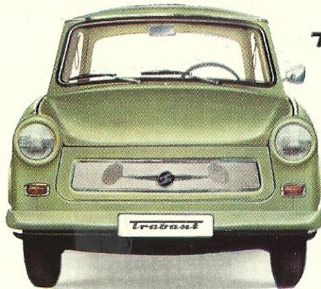
Alle Wagen vom Typ TRABANT 601 haben die gleiche Grundkonstruktion: wirtschaftliches und starkes Fronttriebwerk mit 26 PS Leistung, luftgekühlter Zweizylinder-Zwei-
