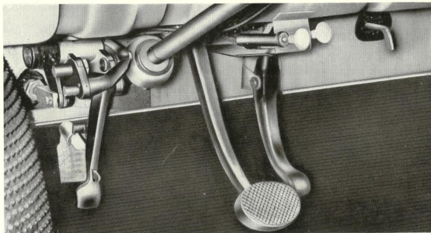
Außer Brems- und Fahrpedal ist lediglich noch ein kleiner Fußhebel zur Betätigung der Parksperre vorhanden
