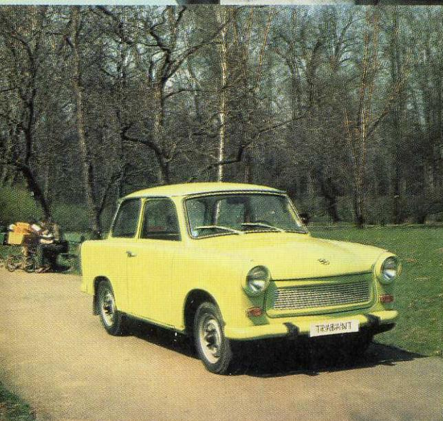
Přední náhon zajišťuje Trabantu 601 mimořádnou stabilitu v zatáčkách. Dvoutaktní bezventilový motor o výkonu 19,1 kW (26 k) je chlazen vzduchem. Palivová nádrž má obsah 24 litrů. Samonosná karoserie z plastické hmoty je zavěšena na plošinovém ocelovém rámu a odpérována listovými pery a teleskopickými tlumiči na předních i zadních kolech.
