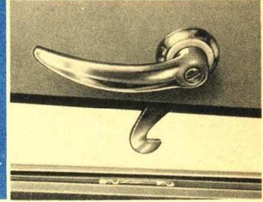
Durch Umschwenken des Griffes wird der Verschluss des Schiebedaches freigegeben, und das Dach läßt sich nach hinten öffnen.
