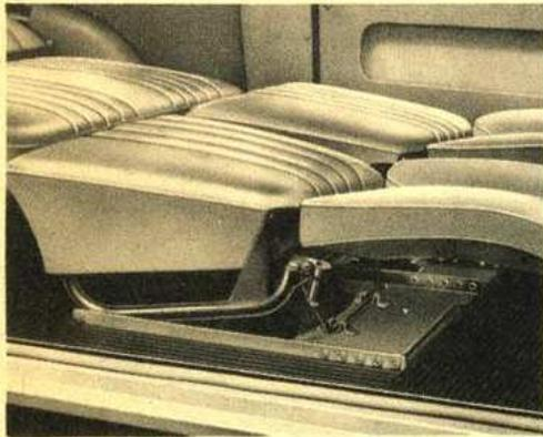
Die Vordersitze werden hinten angehoben, aus der vorderen Arretierung der Gleitschienen herausgenommen und gedreht, so daß die Rückenlehnen zur Instrumententafel zeigen. Der angehobene Sitz wird in die hintere Arretierung eingesetzt und der unten am Sitz befindliche Stützbügel in die Bodenraste eingelegt. Die Stellschraubenbefestigung am Sitzgestell für die Rückenlehnen wird nach unten geklappt und die Lehne nach vorn bis zum Anschlag gelegt.
