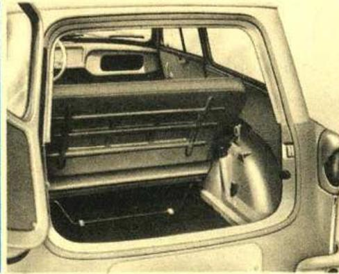
Wie bei den Vordersitzen wird auch bei der Frontsitzbank der unten befindliche Bügel in die Rasten eingelegt und die Sitzbank dadurch angehoben. Die Rückenlehne ist aus der Halterung für die Sitzstellung auszurasen und bis zu den Anschlagwinkeln an der Hinterradverkleidung umzuklappen.
