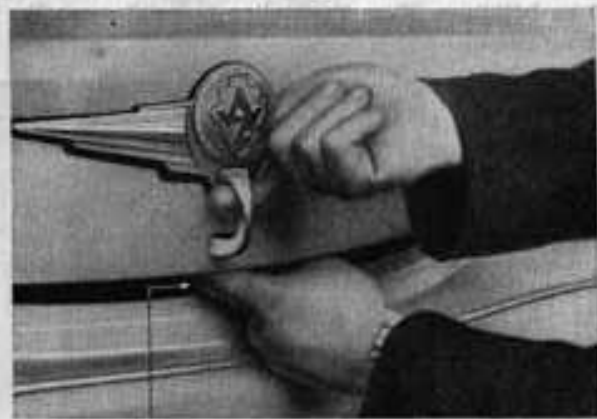
Bild 40. Sicherungshebel für Motorhaube öffnen 1 Hebel nach rechts drücken
