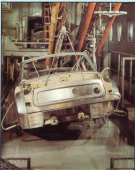
A kocsiszékerey elektróforézises alapozása
