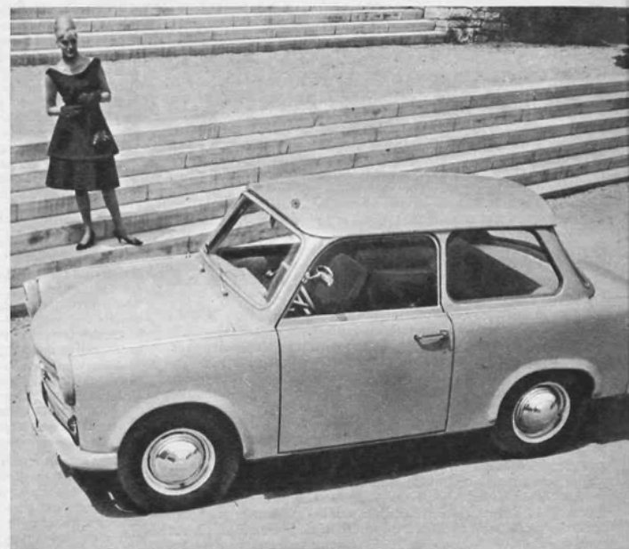
Ausreichende Kopffreiheit für die Fondpassagiere wurde durch die zurückgesetzte Heckscheibe und durch das flache Dach erreicht.
