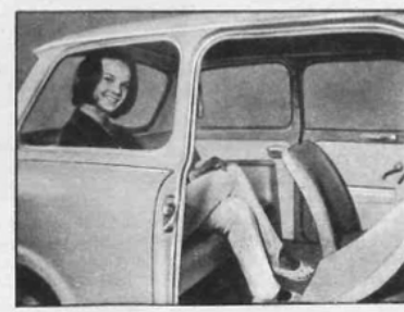
Ausreichende Kopffreiheit für die Fondpassagiere wurde durch die zurückgesetzte Heckscheibe und durch das flache Dach erreicht.
