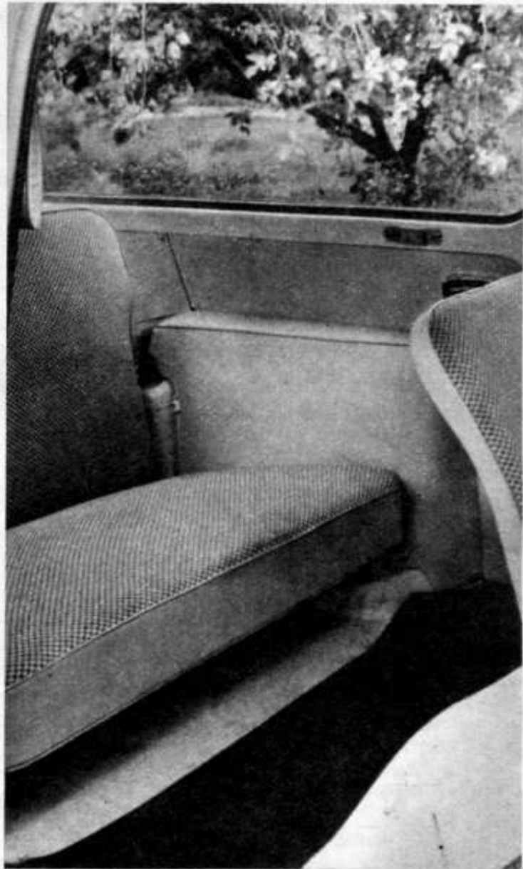
Während bei der Limousine 601 die hintere Lehne und die Sitzbank vor den Stoßdämpfergehäusen liegen, bieten die im Universal zurückgesetzten Sitze wesentlich mehr Kniefreiheit und Bequemlichkeit für die Fondpassagiere.
