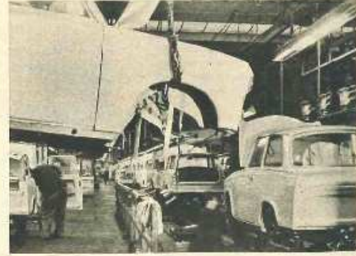
Ein wichtiger Abschnitt: die Übergabestelle vom Karosserieband zum Endmontageband.
