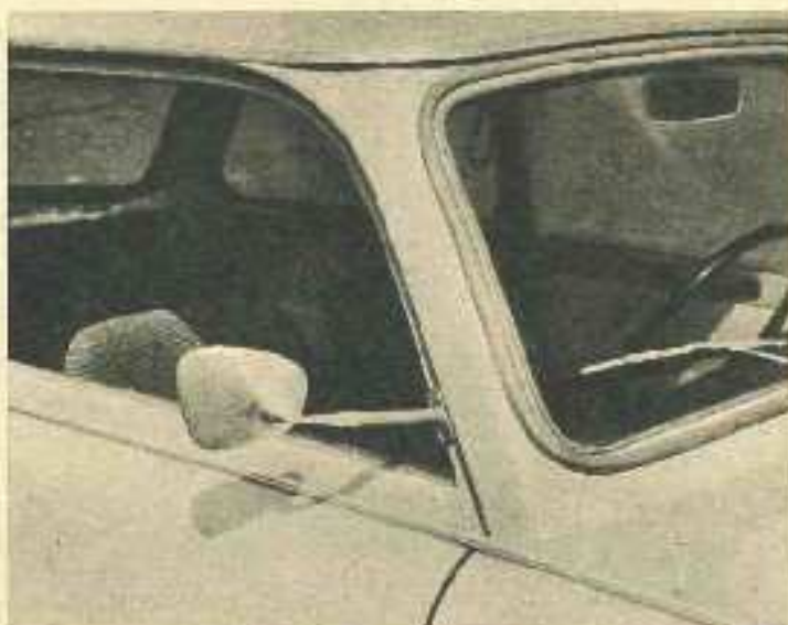
Verlängerte Rückblickspiegel sind mit dem Wohnanhänger unerschütterlich.
