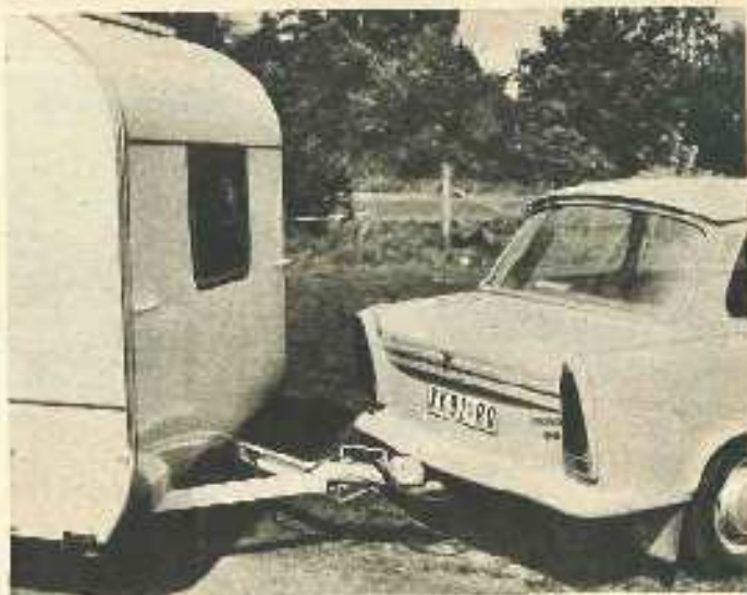
Bei kleinstem Wendekreis ist noch ausreichend Abstand zwischen Anhänger und Pkw.
