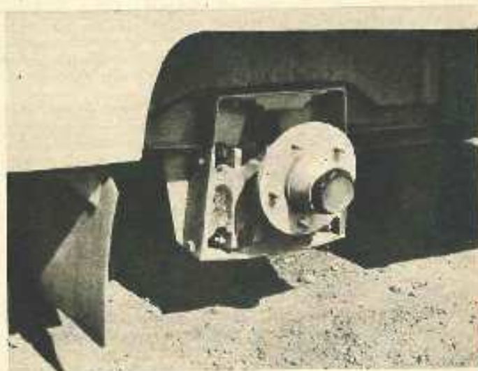
Die auf Schub beanspruchten Gummiblockfedern sind in Radnähe vor und hinter der Achse angeordnet.
