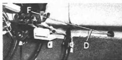
Durch den Beifahrer-Fußraum führt nur noch der relativ dünne Draht (D) der Fernbedienung des Benzinhahns.
