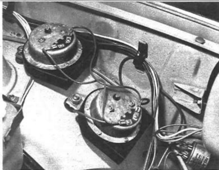
Anstelle eines Horns hat der 601 S de Luxe auf dem linken Radkasten montierte Zweiklangfanfaren, die über ein Relais (rechts unten im Bild) gesteuert werden.
