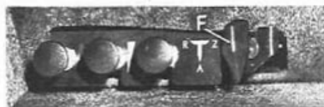
Der Bedienunggriff (F) ist neben den Zugknöpfen für Heizung und Lüftung nicht nur gut erreichbar, sondern auch mit einem Blick sichtbar.
