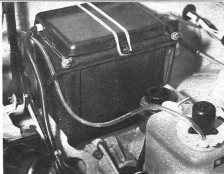
Die große Batterie (6 V/84 Ah) sorgte auch bei Frost unter minus 10 °C für tadelloses Starten. Die elektrische Scheibenwaschanlage erhöhte den Bedienungskomfort.
