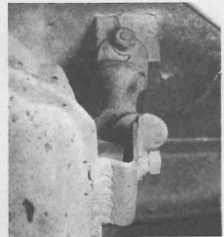
Bild 6 Am Gummielement der Nachschalldämpfer-Aufhängung hatte sich die Vulkanisation gelöst
