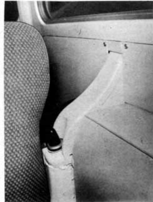
Bild 5 Abstützung der Radschalen zur Seitenwand des Fahrzeuggerippes hin
