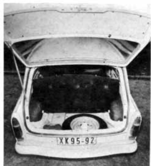
Bilder 2, 3 und 4 Kofferraum hinter der Fondsitzebank, Ladefläche nach dem Umklappen der Fondsitzebank und Reserveradablage im Universal. Die von Hand zu bedienende Stütze der Heckklappe ist nicht ganz unkompliziert zu bedienen
