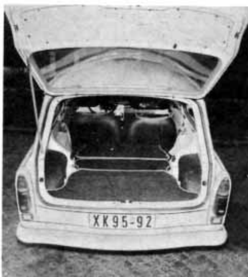
Bilder 2, 3 und 4 Kofferraum hinter der Fondsitzebank, Ladefläche nach dem Umklappen der Fondsitzebank und Reserveradablage im Universal. Die von Hand zu bedienende Stütze der Heckklappe ist nicht ganz unkompliziert zu bedienen
