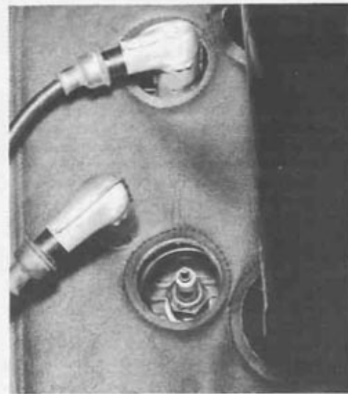
Bild 3 Verriegelung an der Beifahrertür Bild 4 Die kleineren, 14er Zündkerzen
