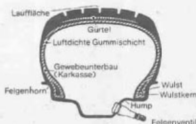
Radial-Reifen schlauchlos
