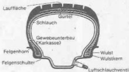
Radial-Reifen mit Schlauch
