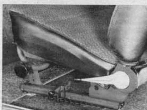
Bild 4 Höhenverstellbarer und kugelgelagerter Vordersitz (Bilder 2 bis 4: Werkfotos)
