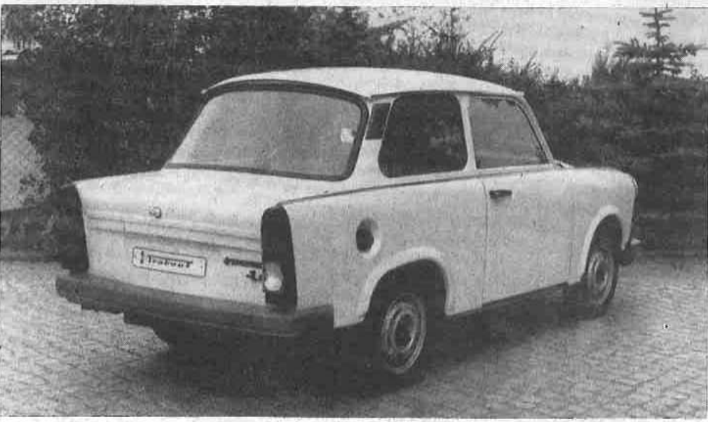
Bild 1 Plaststoßkörper, veränderte Frontschürze und kantige Blech-Motorhaube kennzeichnen den Trabant 1.1.
