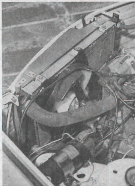
Bild 12 Mit dem Wartburg 1.3 identisch: großflächiger Kühler mit Kühlwasseranschluß auf der linken Seite Bild 13 Der Test geht weiter, wir berichten im nächsten Heft über Fahrleistungs- und Verbrauchsmessungen. (Fotos: Wonnberger)
