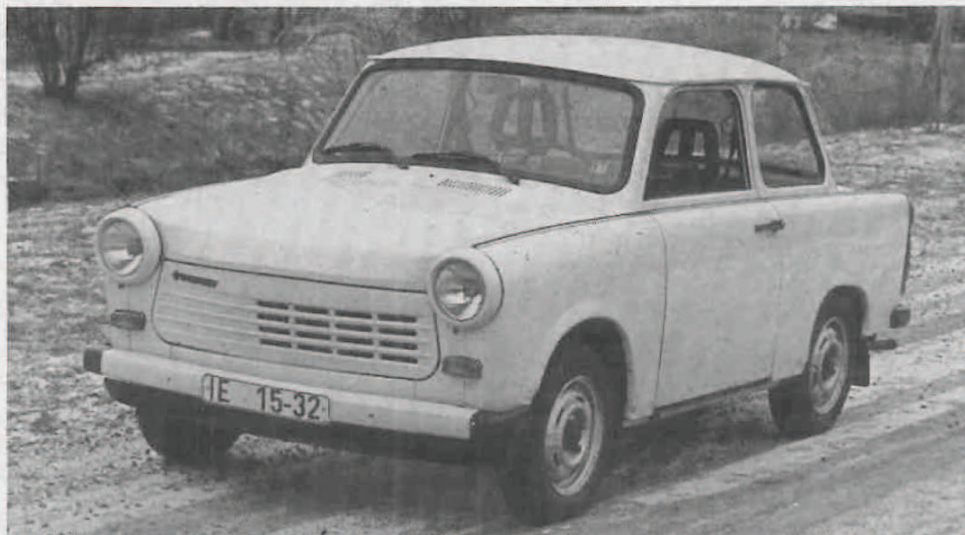
Bild 1 Noch ohne die später serienmäßigen Plaststoßstangen: Trabant 1.1 aus der Vorserie
