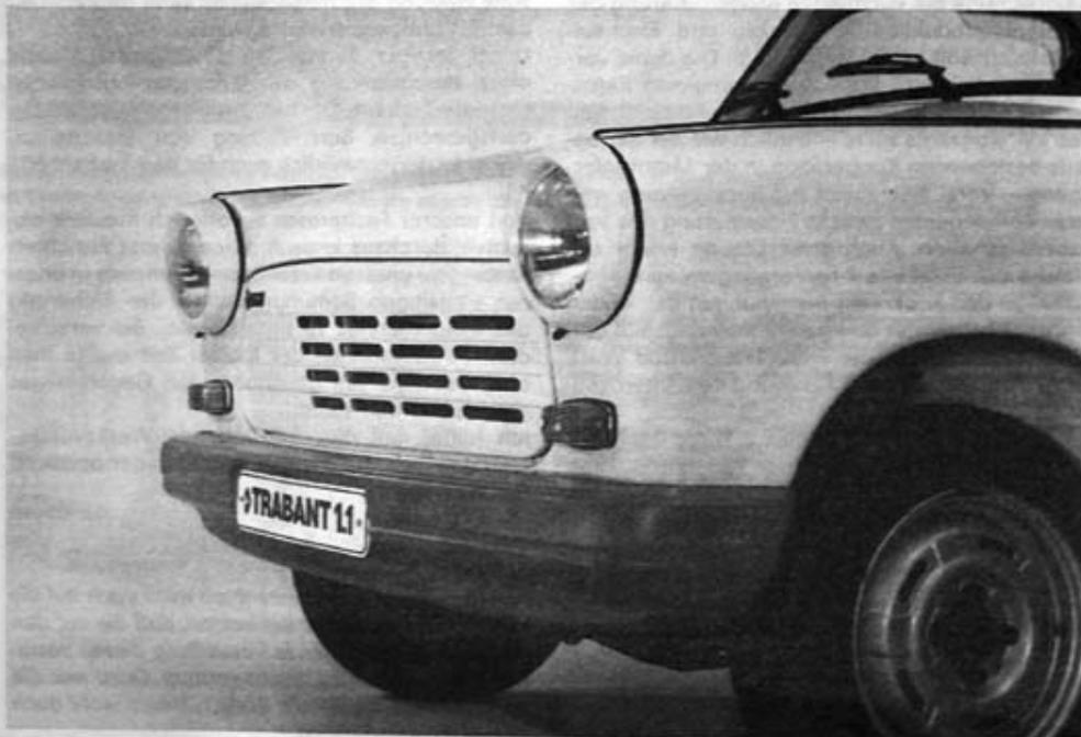
Bild 1 Veränderte Frontgestaltung mit Plast-Stoßstangen
